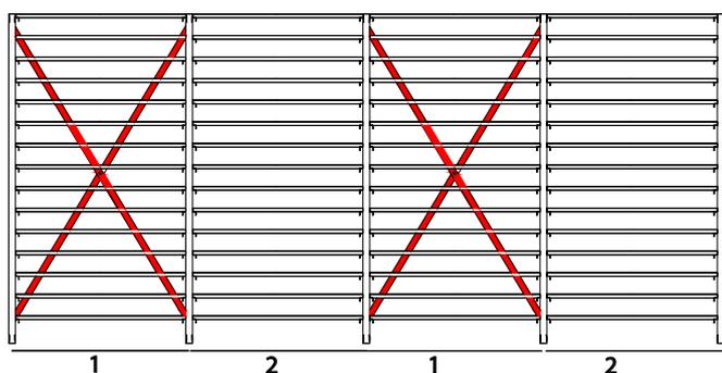
Ogni 2 campate è obbligatorio fissare almeno una crociera di irrigidimento per conferire maggiore stabilità alla struttura. In abbinamento alla crociera è necessario il kit di fissaggio a terra.
