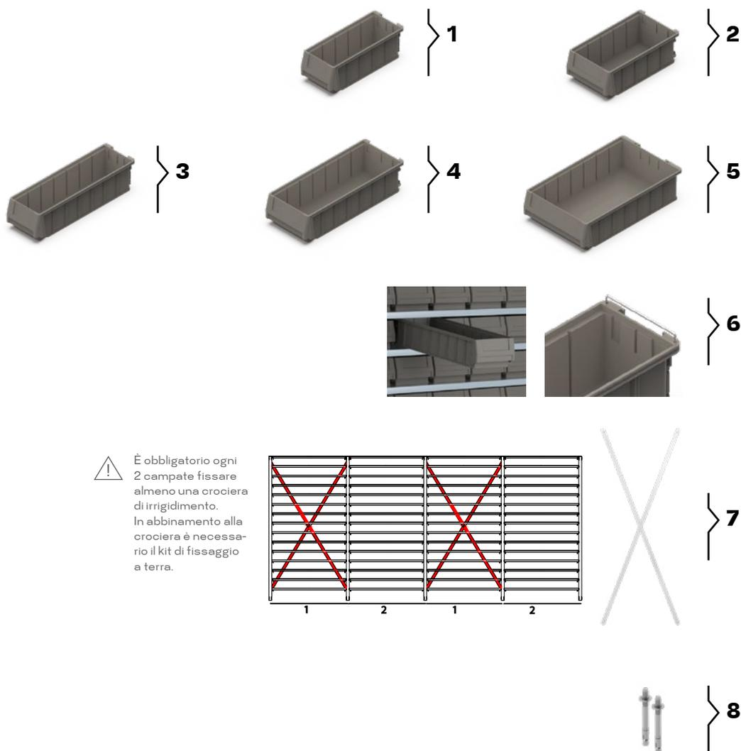
⚠ È obbligatorio ogni 2 campate fissare almeno una crociera di irrigidimento. In abbinamento alla crociera è necessario il kit di fissaggio a terra.
